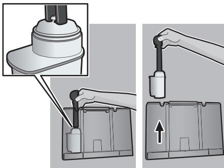
**Info :** le rinçage du filtre **35** a activé le réglage pour l'affichage du changement de filtre.
