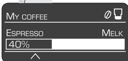
Naast de koffiesterkte en hoeveelheid kan voor de eigen koffie-instelling MY COFFEE nog de mengverhouding espresso-melk worden gekozen. De instelling kan in stappen van 20% worden gewijzigd door aan de draaiknop 6 te draaien.
