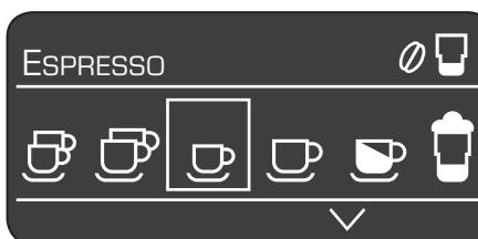
In de regel 'status' **5a** van het display wordt de naam van de drank en de ingestelde sterkte, bijv. **00**, en hoeveelheid, bijv. **□**, vermeld. In de regel 'keuze' **5b** verschijnen symbolen voor de drankkeuze. De pijltjes in de regel 'navigatie' **5c** geven aan in welke richting er zich nog menu-items bevinden.
