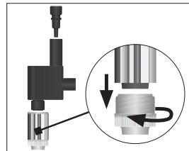
**i** Для обеспечения оптимального функционирования насадки для приготовления мелкочеистой пены проследите за тем, чтобы все отдельные детали были правильно иочно соединены друг с другом.
